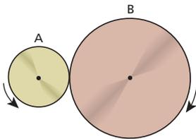
A polia **A** gira com frequência igual a 1 200 Hz, acionada por um motor. A polia **B** também gira, acionada pela polia **A** por meio do contato entre elas. Não há escorregamento entre as polias na região de contato. Determine com que frequência a polia **B** gira.
