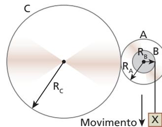
O bloco **X**, que parte do repouso em  $t = 0$ , desce com aceleração escalar constante e igual a  $4 \text{ m/s}^2$ . Não há deslizamento entre as polias. Calcule a velocidade angular da polia **C** num instante genérico  $t$ .
